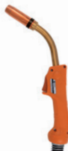
TBi Basic 511 100% (10 мин.) Mix: 350 A CO 2 : 380 A Ø 1.0 - 1.6 мм
